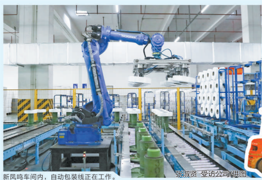
新凤鸣车间内,自动包装线正在工作。
