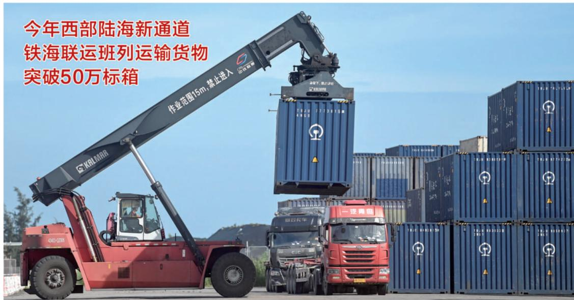
在钦州铁路集装箱中心站货场，一辆正面吊在给货车装运集装箱(8月1日摄)。截至8月2日，今年西部陆海新通道铁海联运班列运输货物突破50万标箱，为历史同期最高水平。《西部陆海新通道总体规划》颁布实施5年来，西部陆海新通道铁海联运班列累计运输货物超310万标箱。新华社记者 张爱林/摄
