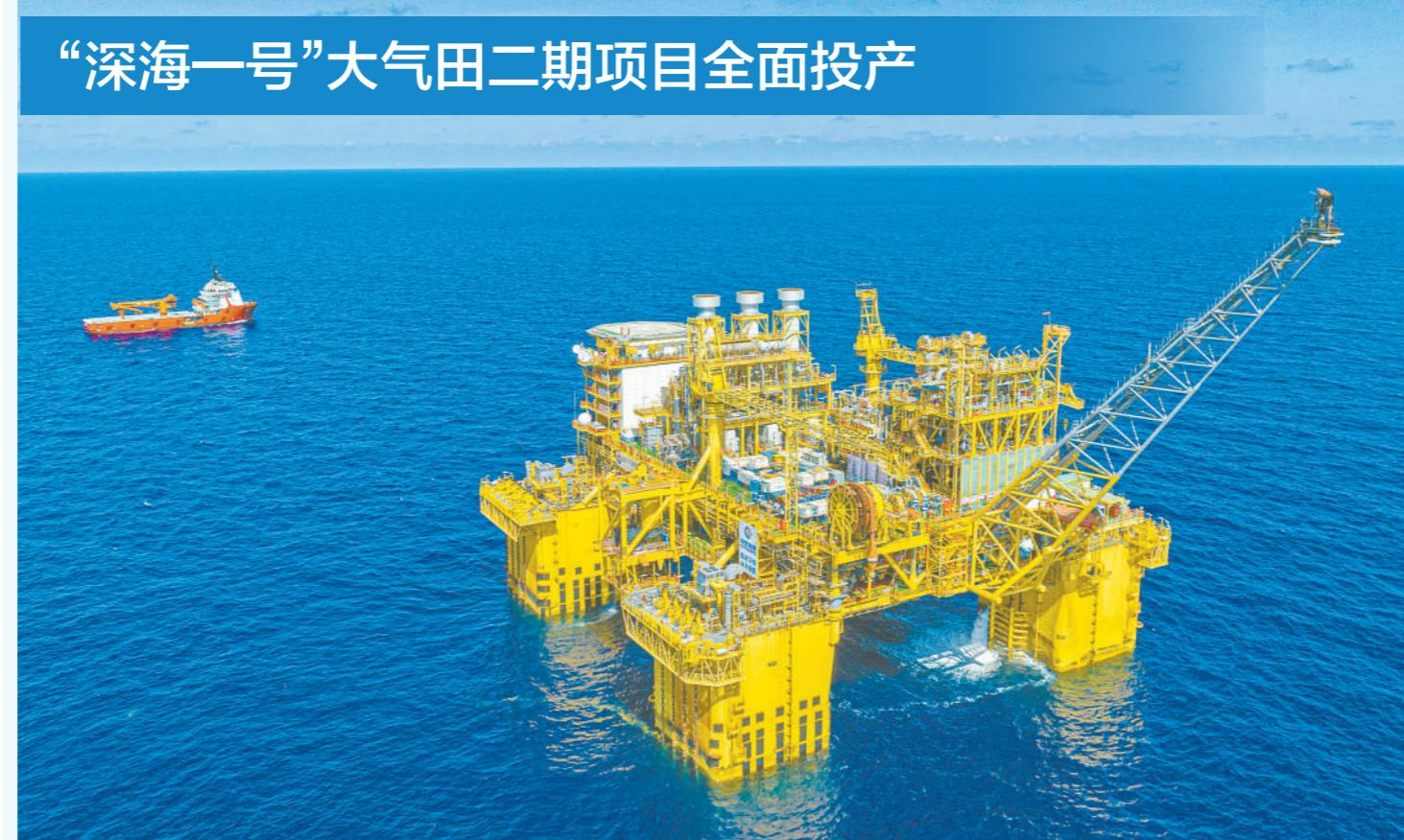
6月25日，中国海油宣布，公司在南海水域的“深海一号”大气田二期项目全面投产，标志着我国最大海上气田建成。“深海一号”大气田一期和二期开发建设（一期于2021年6月投产），探明天然气地质储量超1500亿立方米，最大作业水深超1500米，最大井深达5000米以上，是我国迄今为止自主开发建设的作业水深最深、地层温压最高、勘探开发难度最大的深水气田。图为“深海一号”能源站。
