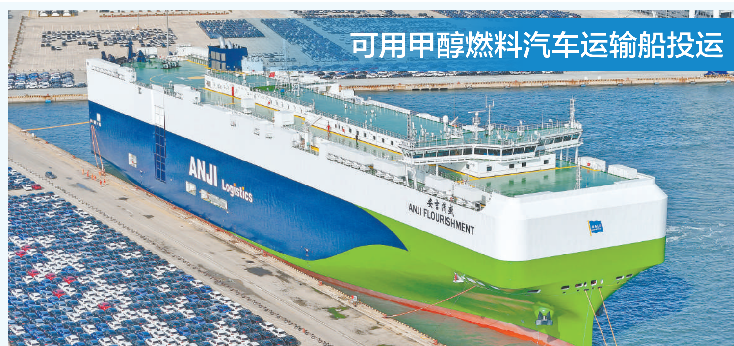
9月21日,于日前交付的远洋汽车运输船“安吉茂盛”轮驶抵山东港口烟台港装载出口汽车。该船由江南造船建造,拥有完全自主知识产权,总长228米,拥有9500个车位,预留超大容积甲醇燃料舱及燃料准备间,具备较强的替代燃料选择灵活性。中新社发 唐克/摄
