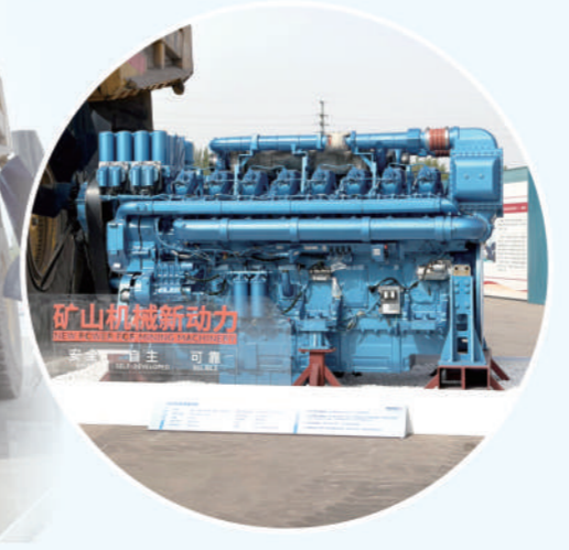
中国首台300吨级矿用12M55发动机完成18000小时高强度可靠运行验收。黄翔/供图
