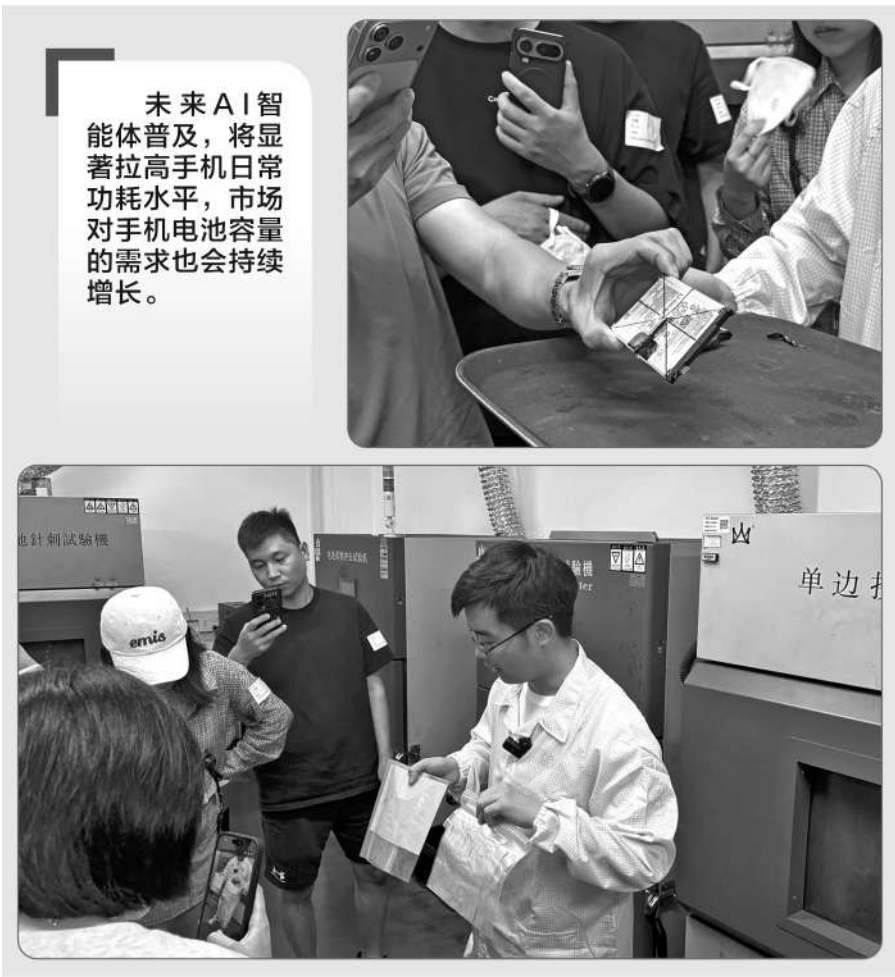
上图为电池穿刺测试，下图为工作人员演示并讲解电池穿刺测试情况。 严翠/摄
