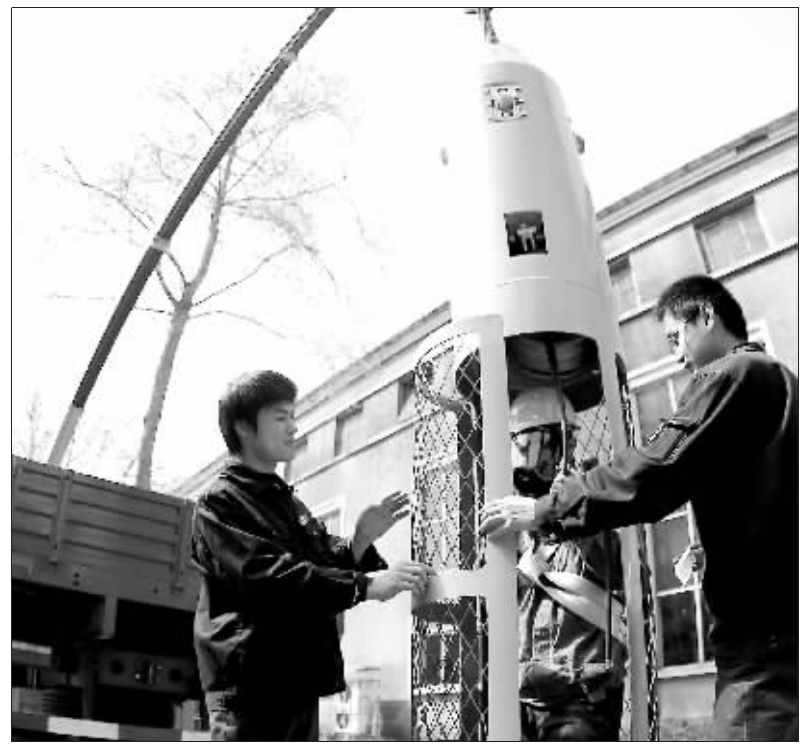
技术人员检测可容纳一人的井下救生舱
