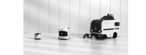
(从左到右依次为:机器人J130室内商用清洁机器人、机器人J40室内商用清洁机器人、机器人J110室外商用清洁机器人)
