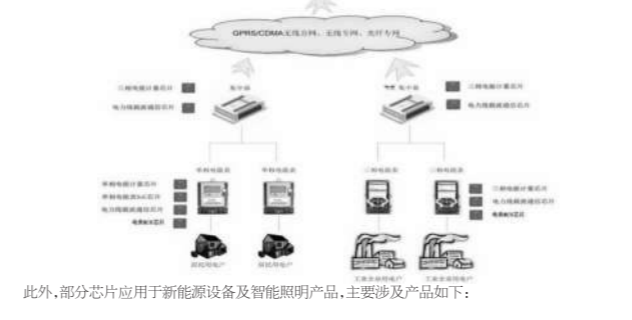
公司计量、MCU以及载波通信芯片产品主要应用于智能电网终端设备,主要应用场景如下图所示:
