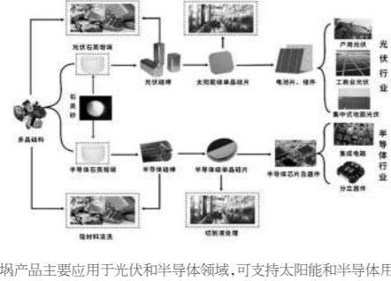
公司石英坩埚产品主要应用于光伏和半导体领域,可支持太阳能和半导体用户高温条件下连续拉晶,其纯度和耐高温耐火性为单晶品质提供保障,是单晶拉制系统的关键辅料之一。在单晶硅片生产流程中,石英坩埚是光伏、半导体单晶炉的关键部件,是拉制单晶硅棒的消耗性器皿,主要用于盛装熔融硅并制成后续产品所需晶棒。基于单晶硅片纯度的需要,石英坩埚一次或几次加热拉晶完成后即报废,需要购置新的石英坩埚用十次拉晶,而在单晶硅片中具备较强的消耗品属性特征。
