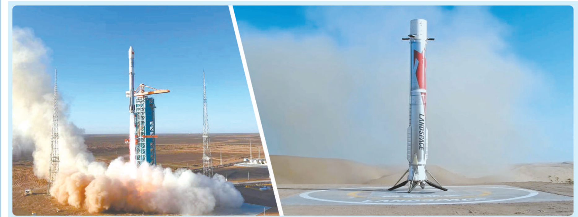
8月19日,蓝箭航天朱雀三号重复使用液氧甲烷运载火箭发射升空,并成功降落在民勤回收场。 蓝箭航天/供图
